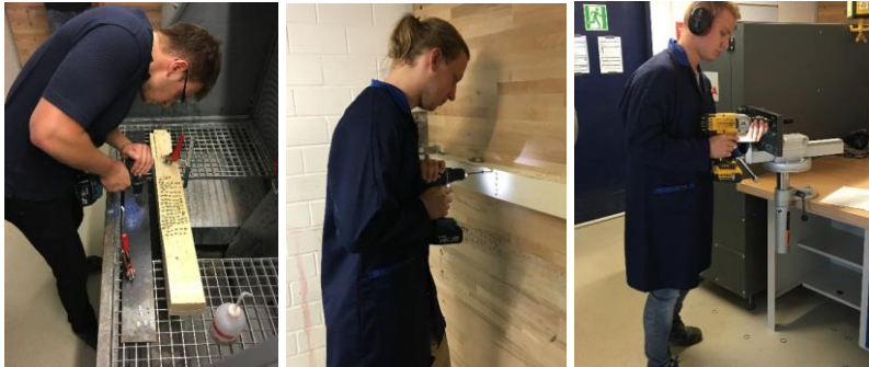
Abbildung 23: Durchführung von Testanwendungen mit Akkuschraubern (links und mittig) und Schlagschraubern (rechts) im Power-Tool Testcenter des IPEK
