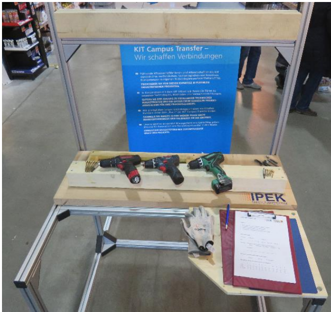
Abbildung 33: Experimentaler Versuchsaufbau zur Beurteilung der Anwendungsqualität von original gelabelten Akkuschraubern 267
