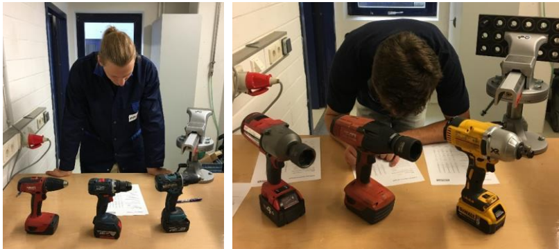
Abbildung 22: Versuchsaufbau der Vorbenutzungsphase zur initialen Bewertung der Griffgeometrie von Power-Tools 234
