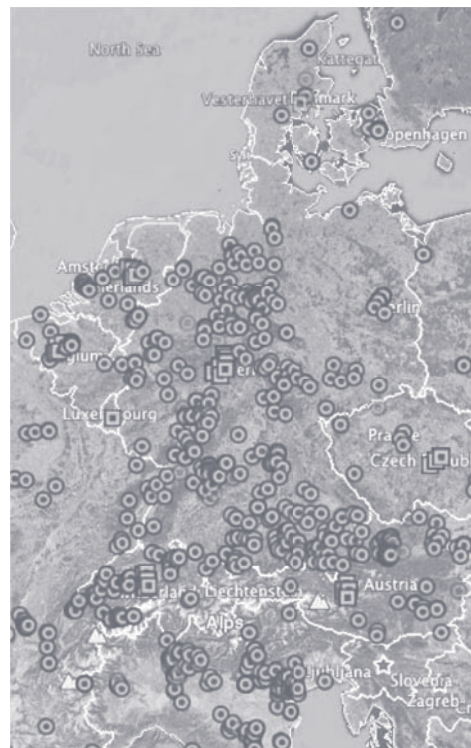
ABB. VI.5 AN DAS INTERNET ANGESCHLOSSENE SCADA-SYSTEME IN DEUTSCHLAND
