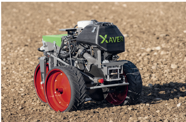
Abb. 3 Fendt »Xaver«: im Schwarm operierende Robotereinheiten
