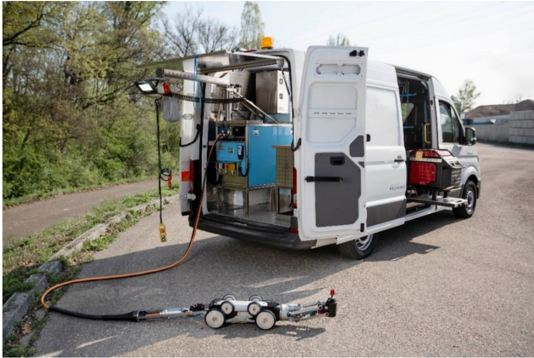
Abb. 4.10 Einsatzwagen und Ausstattung für Robotereinsatz im Kanalnetz
