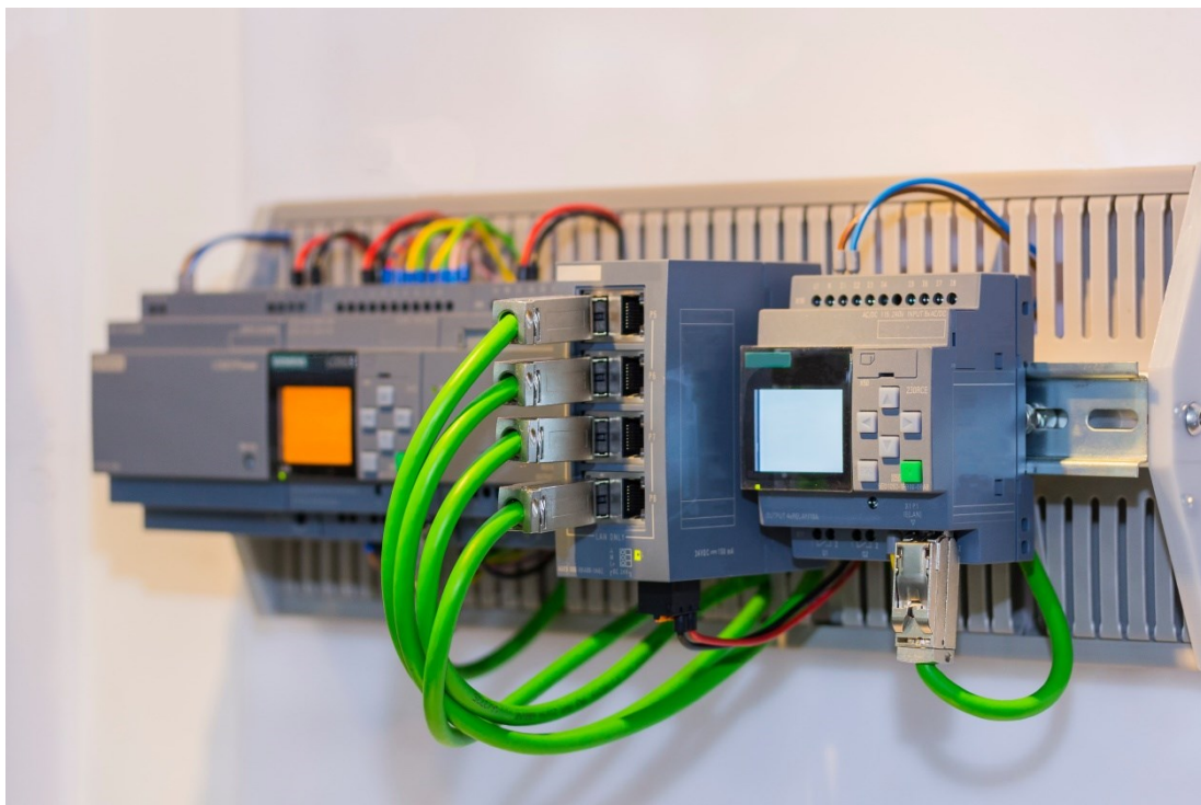
Abb. 4.3 Speicherprogrammierbare Steuerung (SPS)
